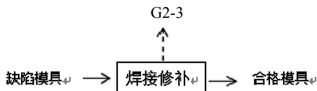
图2-6 模具维修流程图
