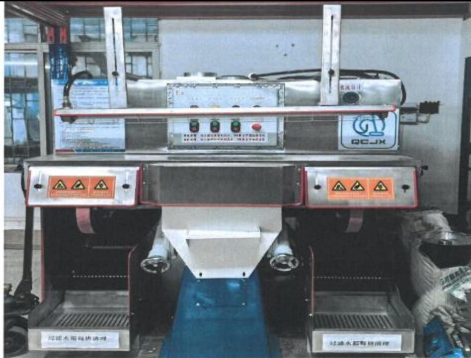
图1 湿式除尘一体机正面照片
