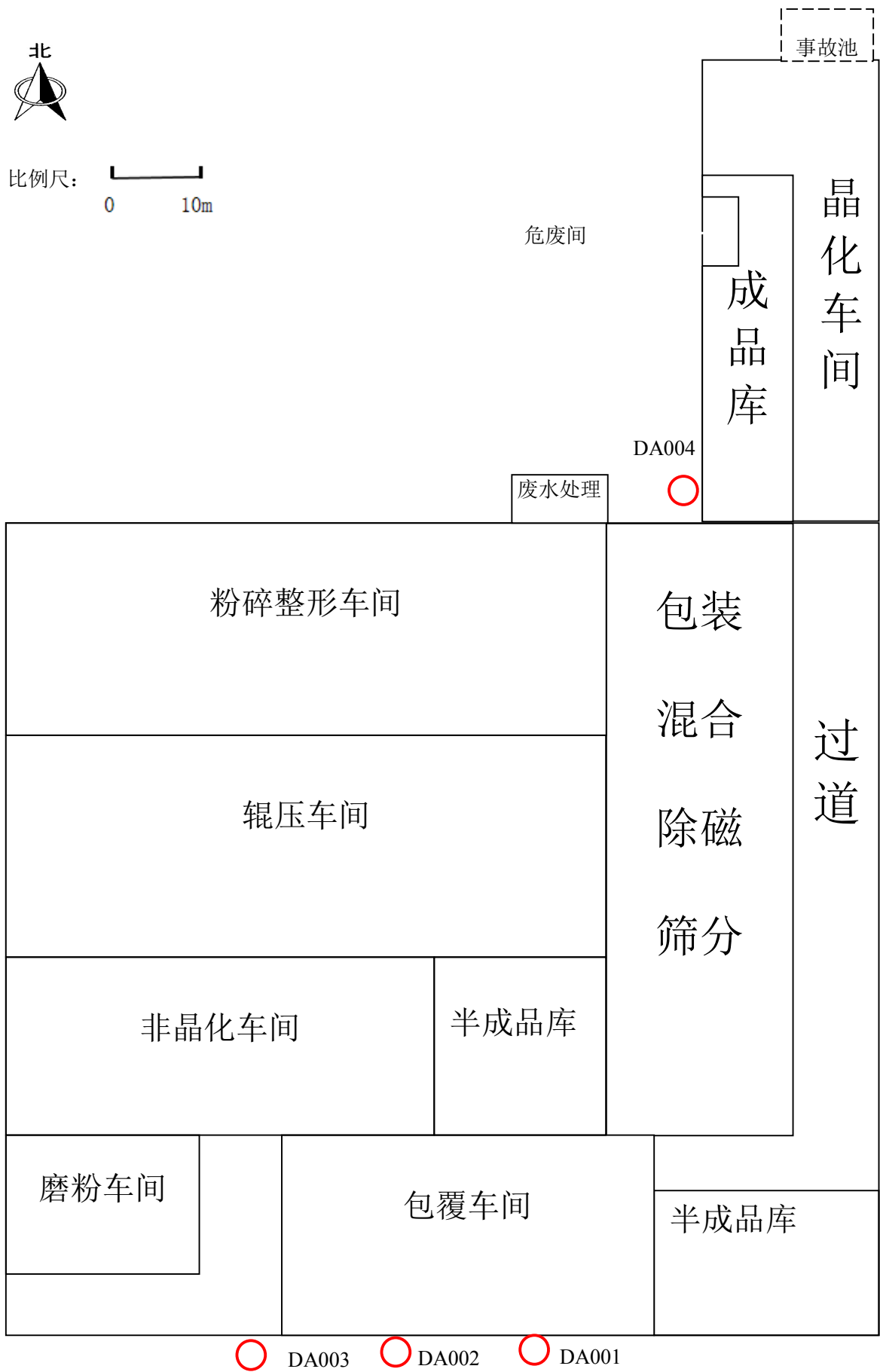
附图五 改建后项目车间平面布置图
